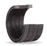
Merkel V-Packung V1000 ist ein mehrteiliger Dichtsatz für die Abdichtung von Kolbenstangen, Plungern und in Sonderfällen von Kolben in anspruchsvollen Anwendungen der Schwerindustrie. Der Satz bestehen aus einem Druckring, i. d. R. drei oder vier Manschetten und einem Stützring. Ein V1000 Dichtsatz wird in drei verschiedenen Ausführungen geliefert: ohne, mit einem oder mit zwei Back-Ringen für eine erweiterte Extrusionsfestigkeit.
