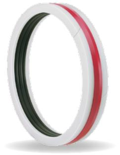
Merkel Kompaktdichtung T 44, ist eine doppelwirkende Kolbendichtung mit einem Dichtelement aus Polyurethan, einem Aktivierungselement aus Elastomerwerkstoff und zwei halbaktiven Winkel-Backringen aus Kunststoff.
