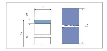
Berechnung der gestreckten Länge L2 für Stangen / Kolben: L2 =  $(D - S) \times 3.11 - 0.5$  / L2 =  $(d + S) \times 3.11 - 0.5$
