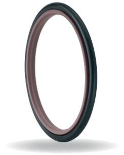
Merkel Omegat OMS-MR DW ist ein zweiteiliger Dichtsatz zur Abdichtung von Kolbenstangen, bestehend aus einem PTFE-Profilring sowie einem O-Ring als Vorspannelement.
