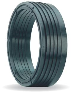
Merkel Dachmanschettensätze der Typen ES und ESV sind mehrteilige Dichtsätze zur Abdichtung von Kolbenstangen, bestehend aus einem Druckring, mindestens 3 Manschetten und einem Stützring. Die Dachmanschettendichtsätze werden in 3 verschiedenen Ausführungen zusammengestellt:
