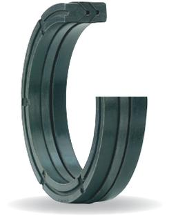
Merkel Dachmanschetten-Dichtsatz EK/EKV ist ein mehrteiliger Dichtsatz zur Abdichtung von Kolben, bestehend aus einem Druckring, einer oder zwei Manschetten und einem Stützring.
